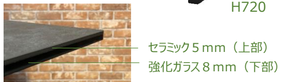
天板はセラミックと強化ガラスの二層構造 ※セラミックと強化ガラスは貼り合わせ
